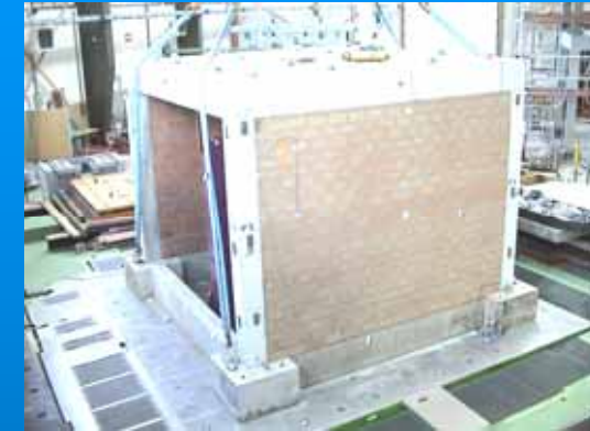
Série n°3: Janvier 2005 portique avec 2 murs en briques (fort niveau)
